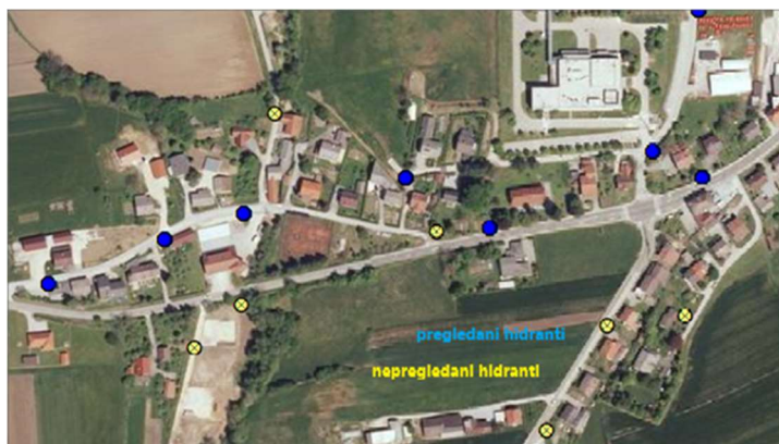
Slika 1: Stanje pregleda hidrantov
